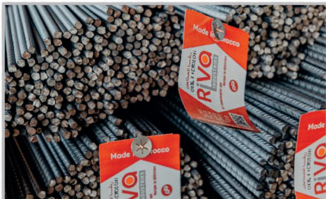
Barres de Fer à béton Fe-500 soudable, obtenues par laminage à chaud et utilisées pour constituer les armatures des constructions en béton armé.
